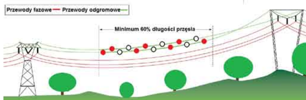
Ryc. 7. Sposób rozmieszczenia kul – widok z boku (na podstawie APLIC 2012). Fig. 7. Placement of sign spheres – side view (after APLIC 2012).
