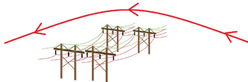
Ryc. 4. Lokalizacja dwóch linii zwiększająca ryzyko kolizji (na podstawie APLIC 2012). Fig. 4. Location of two power lines increasing collision risk (after APLIC 2012).
